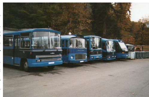
À part les modifications destinées au transport de personnes sur brancard ou en fauteuil personnel, ces bus conservent l'essentiel des caractéristiques de bus urbains, proches de la chaussée, sans coffre à bagages et d'une longueur limitée à 12 m pour faciliter la circulation en ville et dans les cours des accueils.
